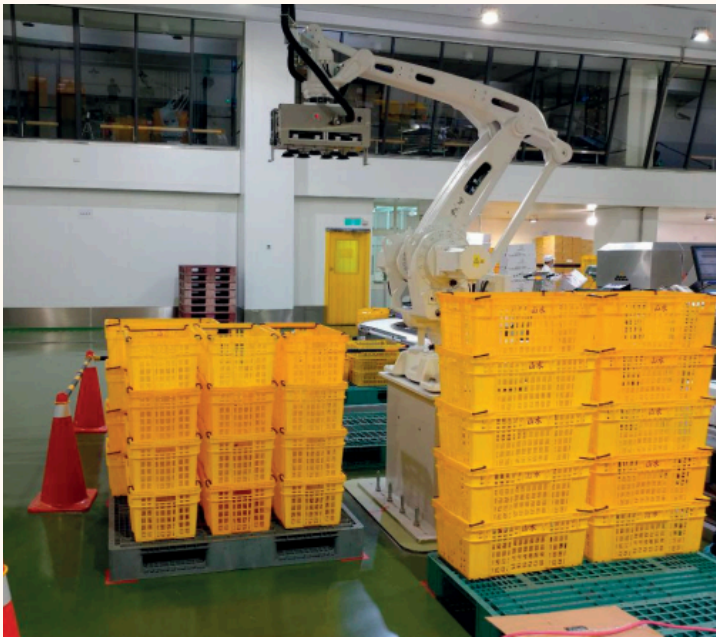
▲用機械手臂取代人工搬運雞蛋，減輕人力負擔。 圖片來源：智慧農業新聞
