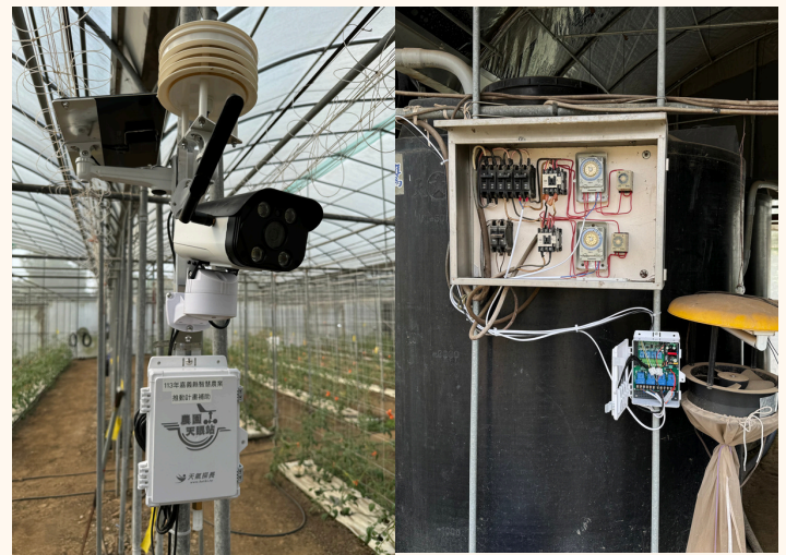
▲ 微氣象站(左)、遠端控制設備(右) 圖片來源：嘉義縣政府農業處
