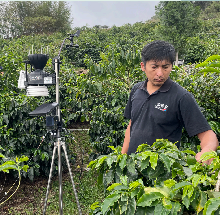
▲ 鄒族園咖啡莊園裡的微型氣象站 圖片來源：嘉義縣政府農業處
