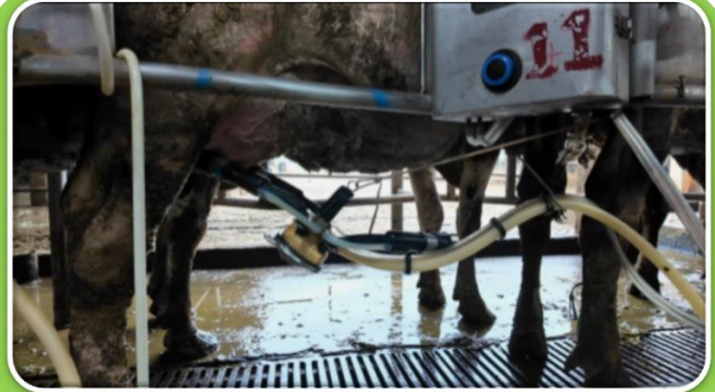
自動脫杯榨乳機，經智慧化判斷乳汁多寡，在無乳隻時迅速脫杯避免乳頭，因為過榨導致乳房炎的情況，在夏季乳房炎高峰期，可以減少50%以上的乳房炎發生率。(畫面為托杯機已偵測到乳量減少，正要脫杯的當下。)
