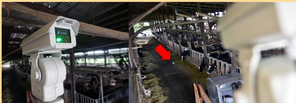
AI雷射驅鳥器，搭載4K光學鏡頭結合AI邊緣運算技術，能自動鎖定野鳥位置再搭配高功率綠點雷射光(紅箭頭處)，以達到驅離野鳥效果。
