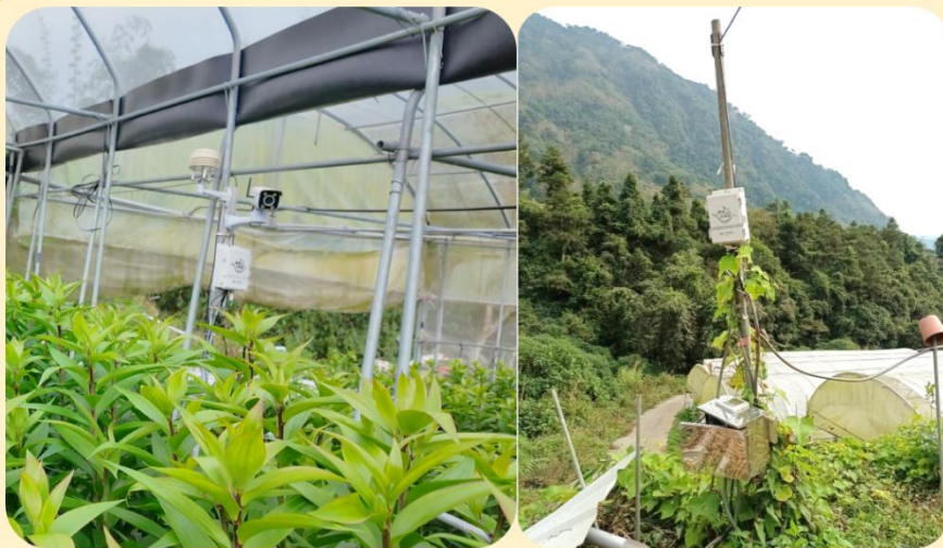
於百合植株之間裝設微氣象站和設置灌溉控制系統，可於手機連網觀看氣候數據以及控制灌溉馬達開關。
