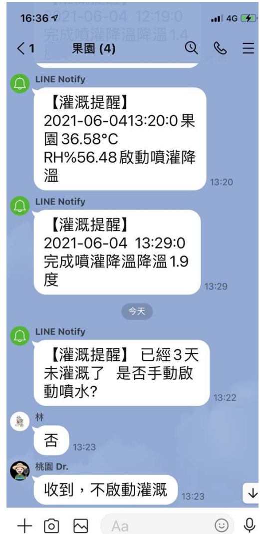
圖 3 物聯網智慧溫控系統 人機共同決策示意圖
