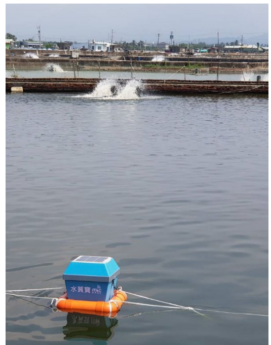
圖 3 水質寶水質監測設備
