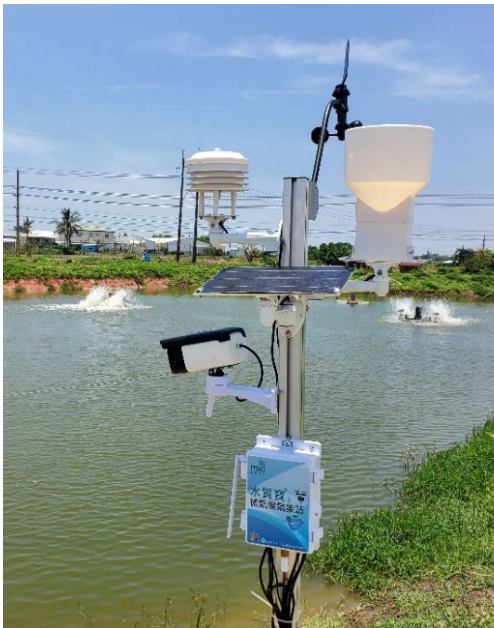
圖 6 魚塢旁邊的微氣候氣象站
