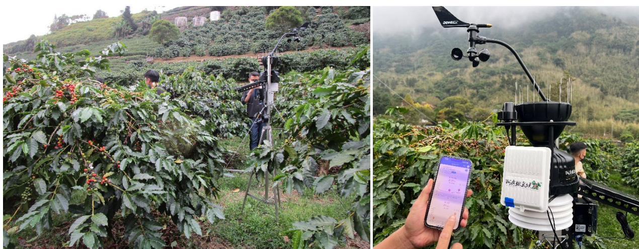
圖 1 鄒築園的微氣候氣象站架設於咖啡植株之間，以手機應用程式即可觀看氣候數據。
