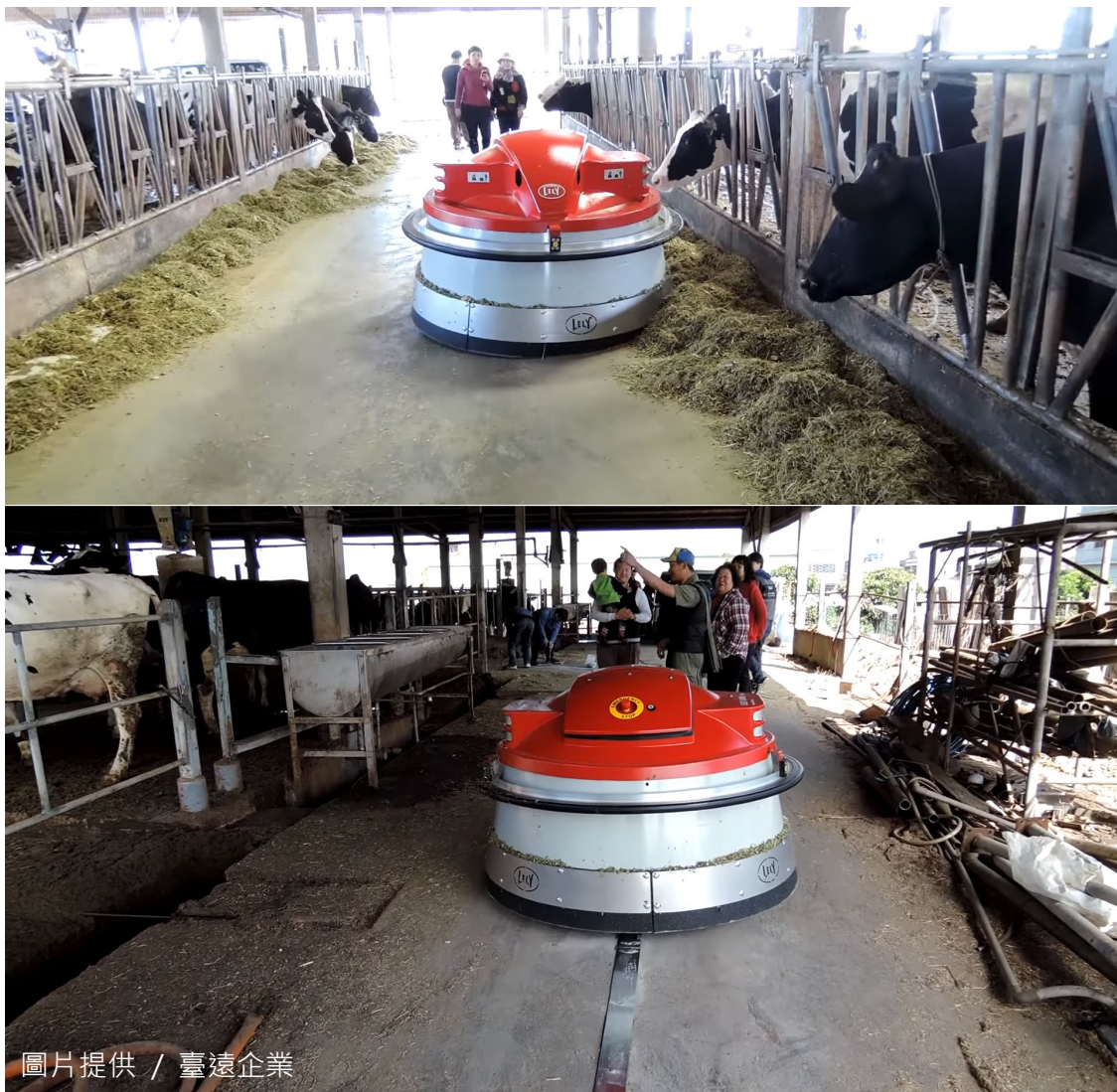
圖 4 與 Lely Juno 同系列的 Lely Juno 150 智慧型自動推料機，利用地面的金屬軌道導航，但是一旦進入餵飼走道，機器便改為以超音波偵測機體與頸夾的距離而移動，因此不必在餵飼走道增設金屬軌道。
