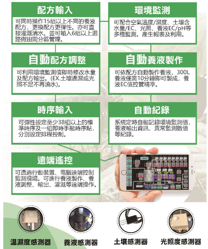
圖 5 智能水養液供應系統的功能
