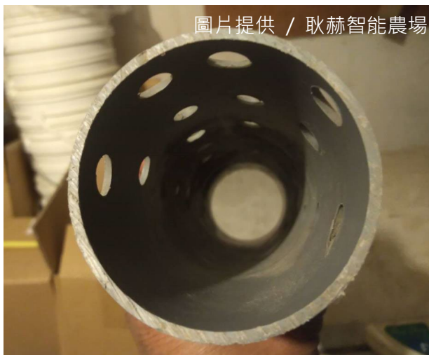
圖 3 暗渠系統 PVC 管鑿孔與包覆紗網
